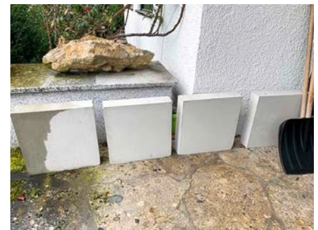
(7) Labormuster für die Farbtonfestlegung auf Basis von vier verschiedenen robusten Betonsorten: Erprobt wurde u. a., welche Betonsorte bessere Eigenschaften hinsichtlich der Durchfeuchtung und des Hydrophobierungseffekts besitzen.
